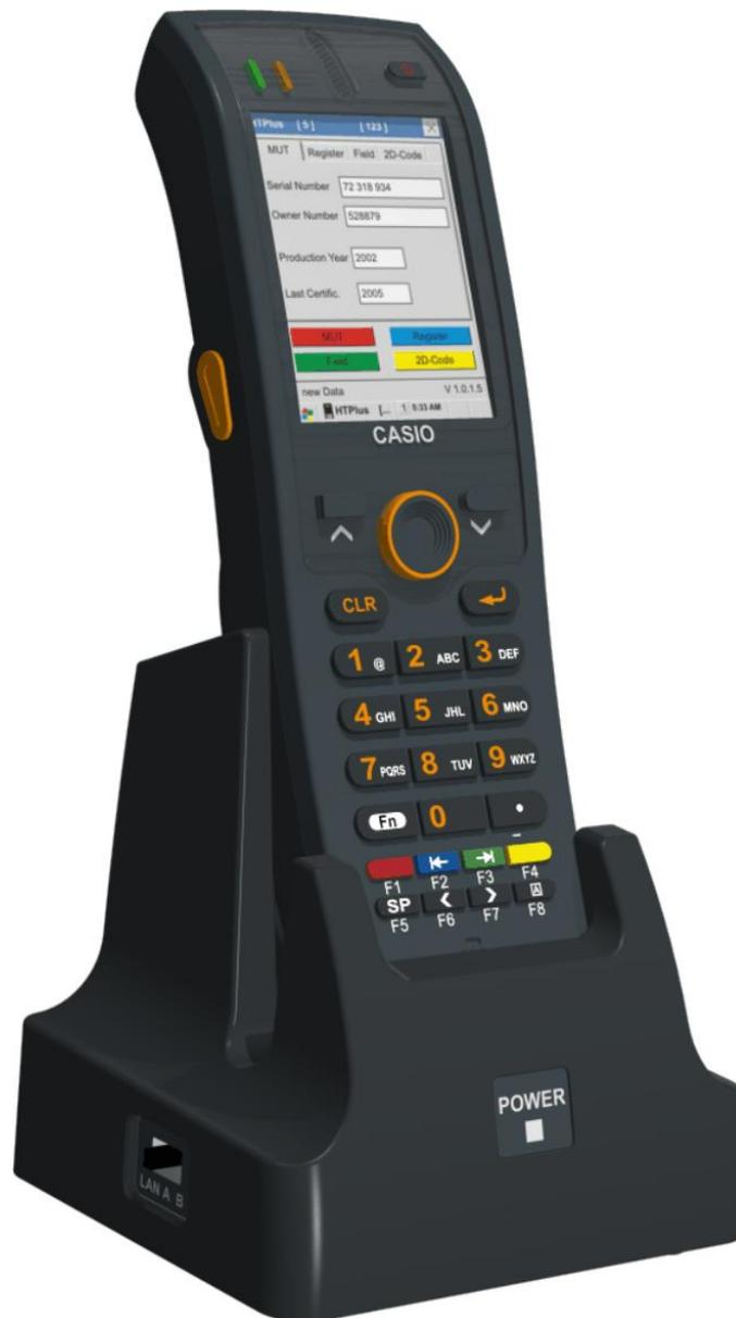
Le terminal portable HT 2010 facilite considérablement la saisie des données des compteurs, en permettant de saisir les données directement sur les compteurs testés.
